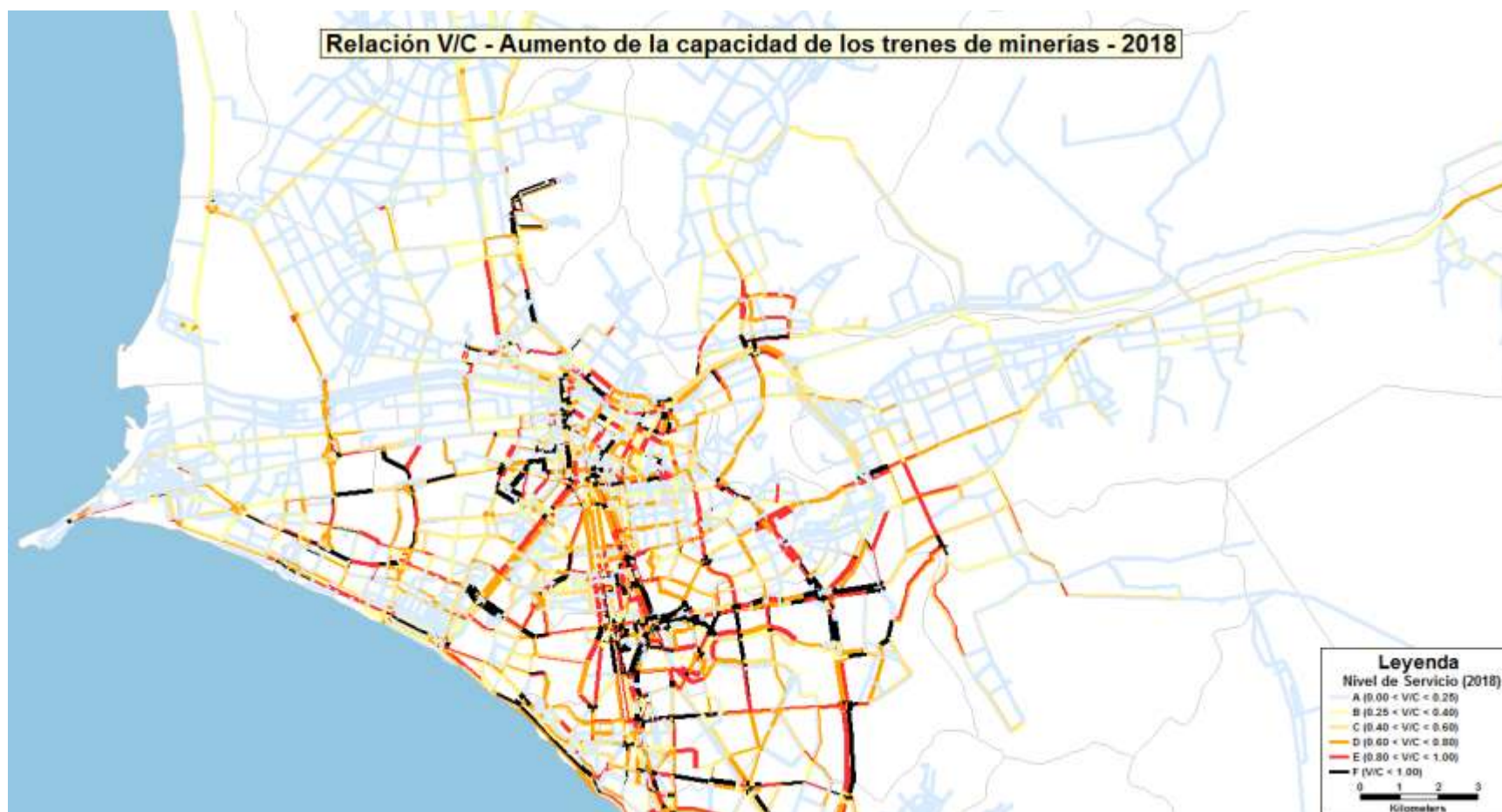
Figura 177. Relación volumen/capacidad para la Red de 2018 considerando la ampliación del Ferrocarril Andino para el transporte de 100% de los productos de la actividad de minería – Pico Tarde
