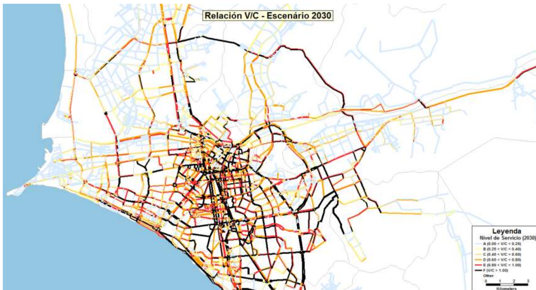
Figura 186. Relación volumen/capacidad para la Red de 2030 considerando solamente el crecimiento vegetativo, sin cambios en la red – Pico Tarde
