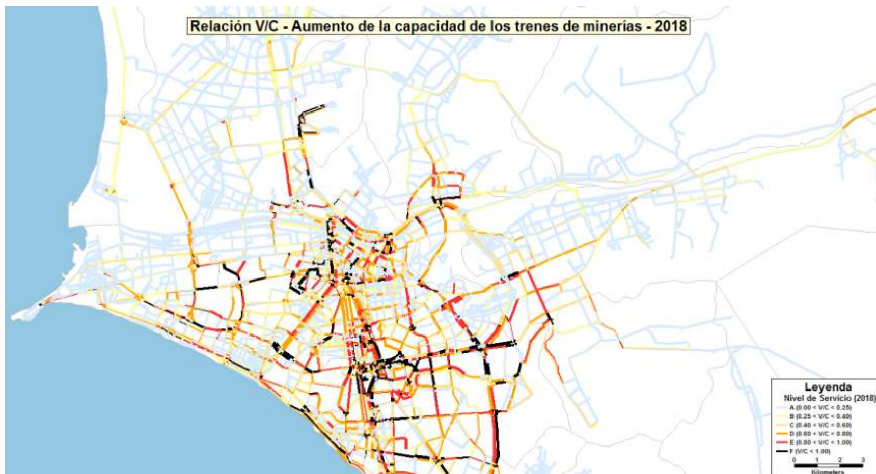
Figura 176. Relación volumen/capacidad para la Red de 2018 considerando la ampliación del Ferrocarril Andino para el transporte de 100% de los productos de la actividad de minería – Pico Mañana
