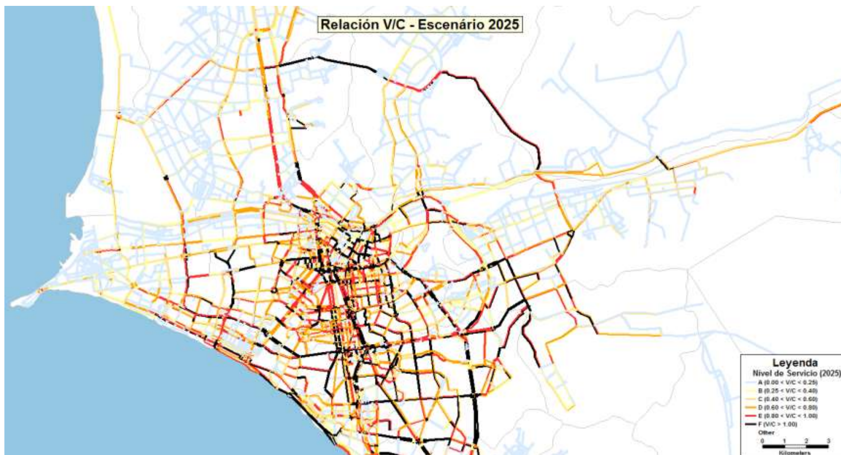
Figura 183. Relación volumen/capacidad para la Red de 2025 considerando solamente el crecimiento vegetativo, sin cambios en la red – Pico Tarde
